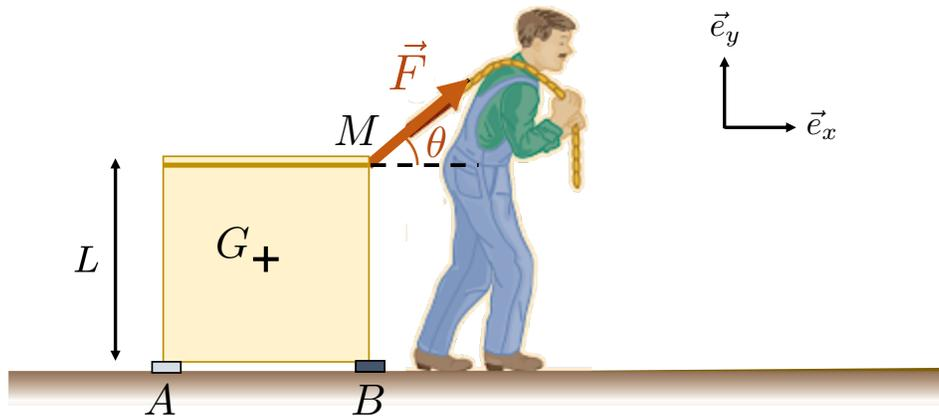
On considère un problème à deux dimensions ( $\vec{e}_x, \vec{e}_y$ ). La caisse a deux points de contact avec le plancher,  $A$  et  $B$ . Le patin censé assurer le glissement ayant sauté en  $B$ , on considèrera que le contact se fait sans frottement en  $A$ , et avec frottement en  $B$  (coefficient de frottement statique entre la caisse et le plancher  $\mu_s = 0,5$ ).
