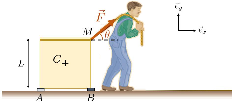
On considère un problème à deux dimensions ( $\vec{e}_x, \vec{e}_y$ ). La caisse a deux points de contact avec le plancher,  $A$  et  $B$ . Le patin censé assurer le glissement ayant sauté en  $B$ , on considérera que le contact se fait sans frottement en  $A$ , et avec frottement en  $B$  (coefficient de frottement statique entre la caisse et le plancher  $\mu_s = 0,5$ ).
