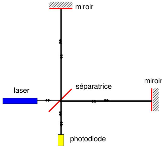
FIG. 35: Principe de l'interféromètre à laser.
