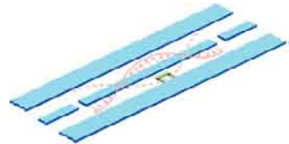
Circuit QED avec jonctions Josephson couplées à des lignes coaxiales
